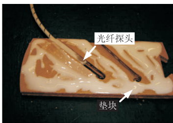
(c) 光纤探头布置方式
